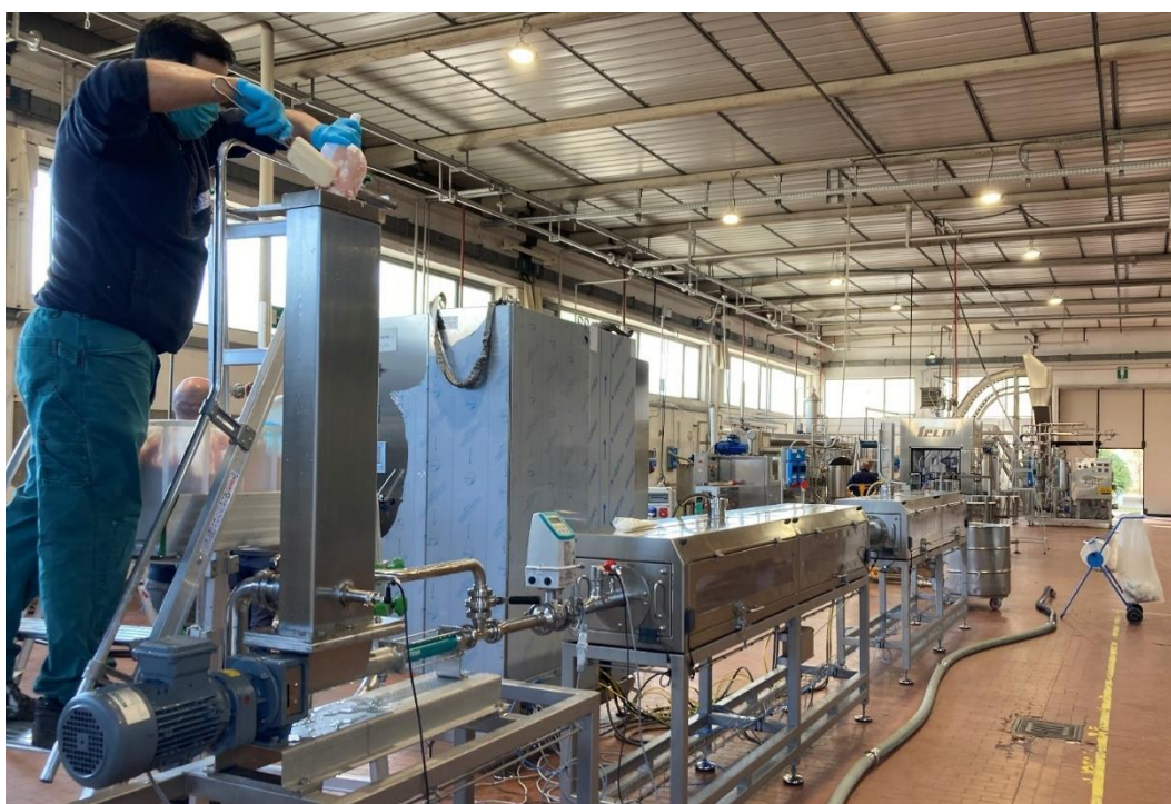
Figur 2. Første kørsel på det nykonstruerede OH-anlæg i Parma, marts 2022. Øverst: Anlægget i sin helhed. Nederst: En operatør fylder fars i tragtten til anlægget (design af tragt senere ændret), en snekepumpe flytter farsen forbi flow-, temperatur- og ledningsevne målere, inden den passerer de to celler, hvor strøm påføres.
