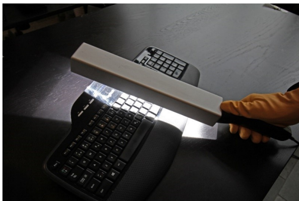
Figur 11 Foto af LED iBonds batteridrevet og håndholdte overflade desinfektions system, purizap. Kræver beskyttelse af hud/hænder og øjne.
