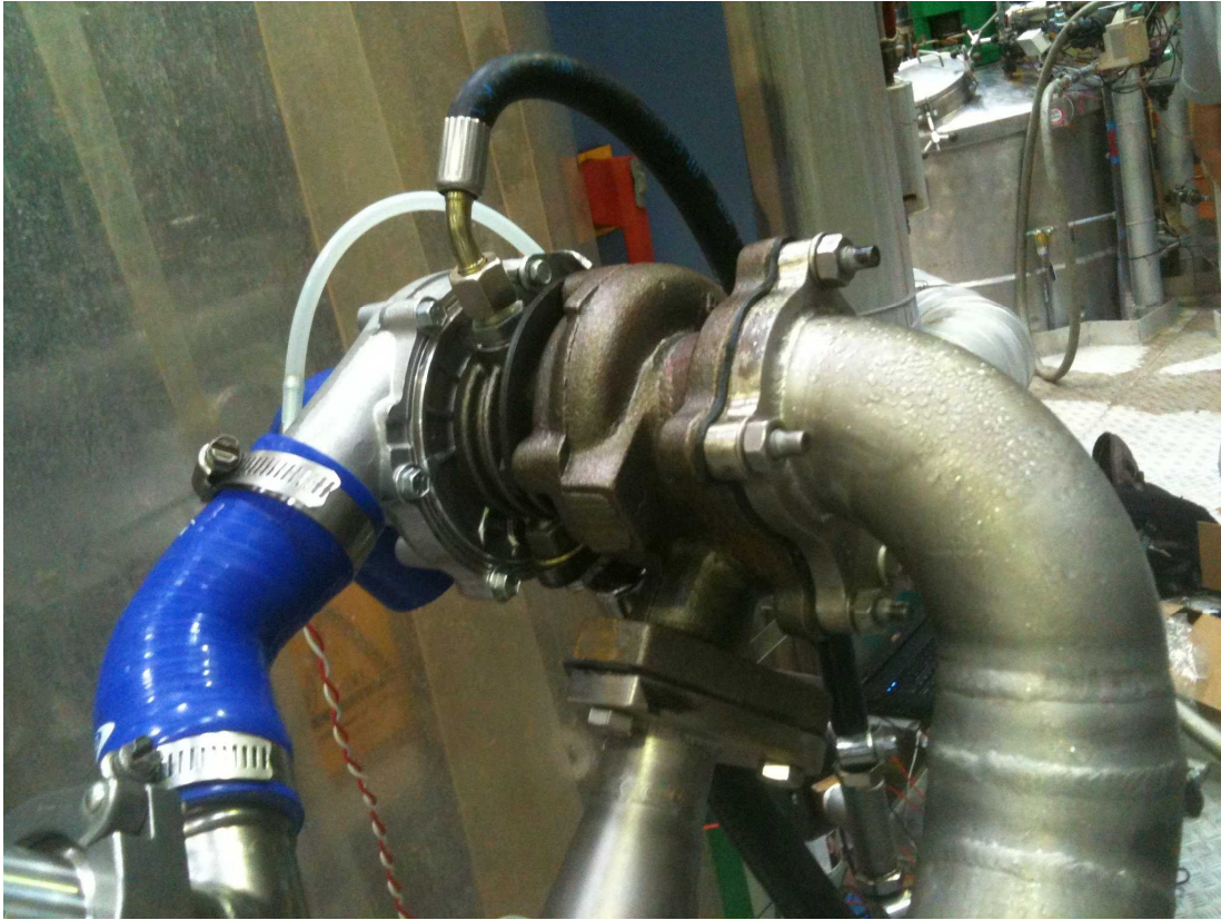
Figur 4. Turboladeren under forsøg med tør luft. Bemærk udkondensering af vand på overfladen af udløbsbøjningen, som viser at temperaturen i udløbet fra turbinen er væsentlig lavere end dugpunktet i omgivelserne.
