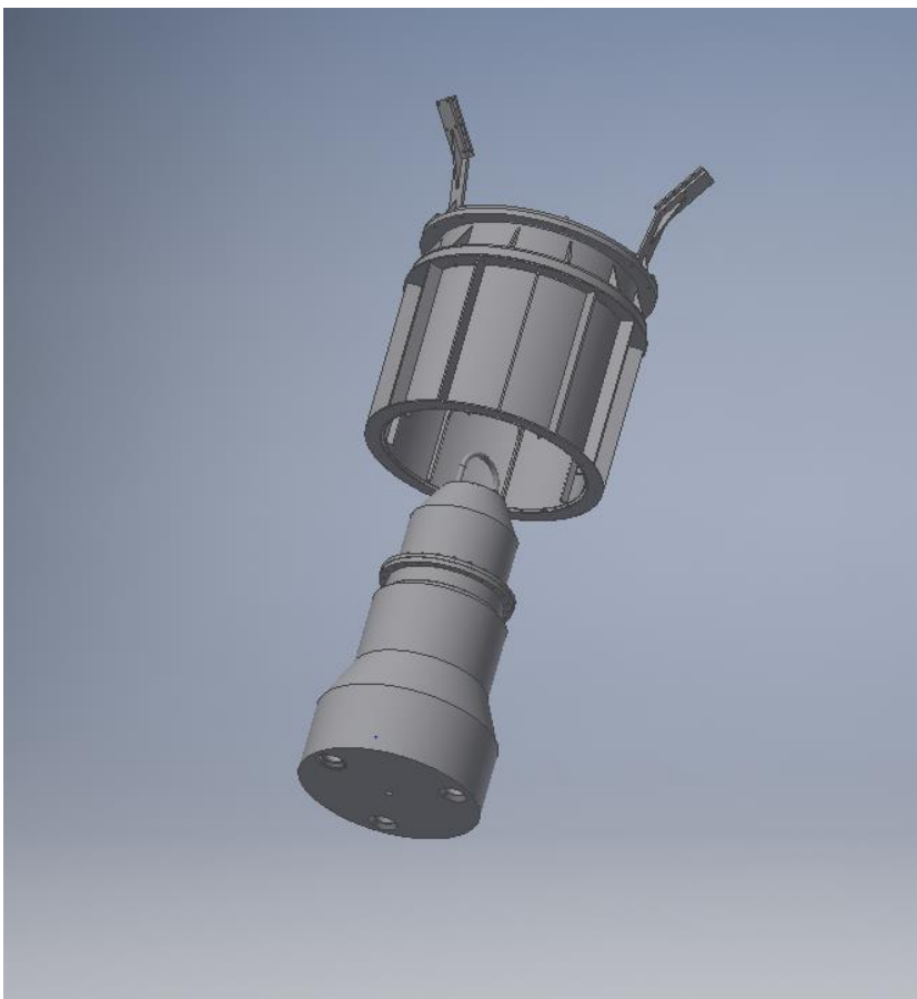
Billede 52) Inventor tegning af forankringssystemet adskilt
