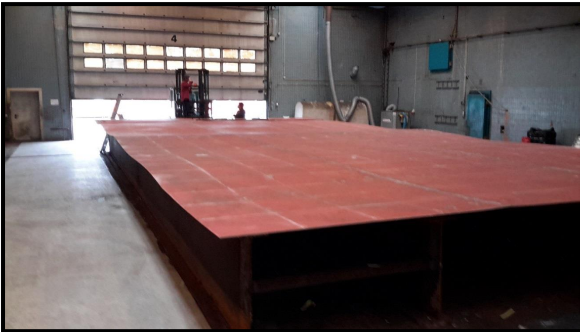
Billede 3 og 4) Agter ponton køl lagt.
