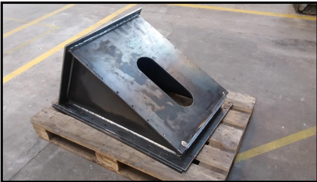
Billede 39) Del af tætningskassen, yderlige komponenter til den er under fremstilling.
