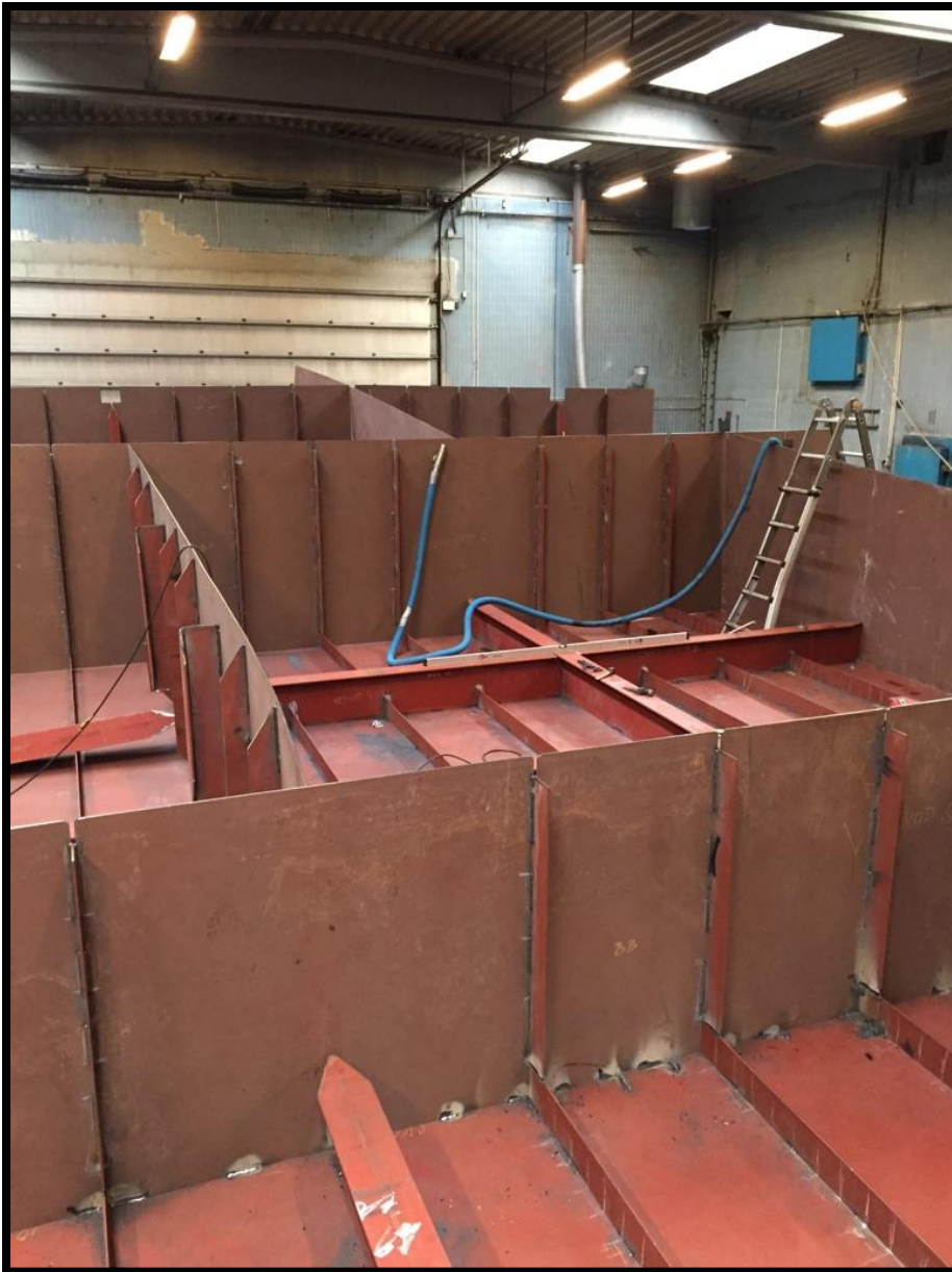
Billede 5) Køl, webbjælker, skodder, og spanter i agter ponton på plads
