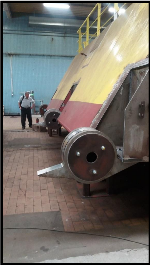
Hængslerne boltet fast på den ene side.
