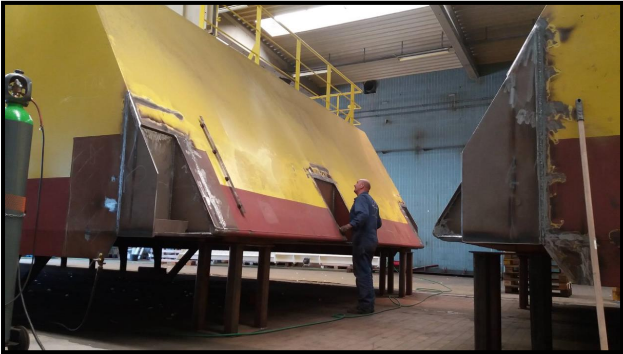
Forstærkning til hængsler færdig isat og svejst
