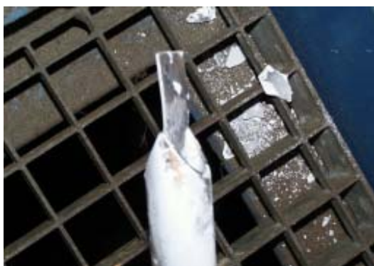
Figur 7: Tilstopning af lanse ved provisorisk SO 2 -probe.
