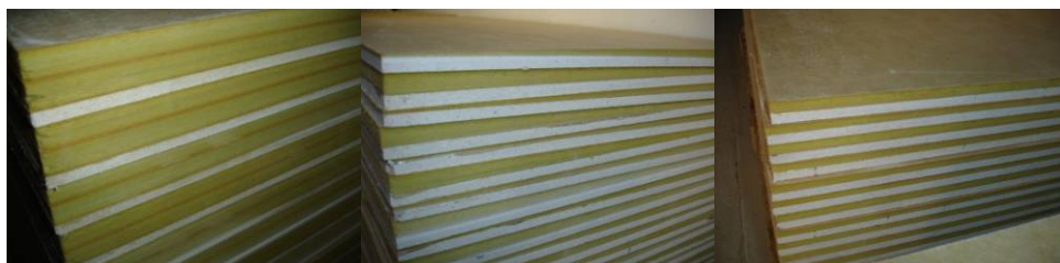
Figur 6: Aerorock i forskellige udgaver. Fra venstre: 2x20mm + gipsplade (indvendige vægoverflader), kilemodul (skillevægge og lofter) samt 1x10 mm + gipsplade (lysninger)
