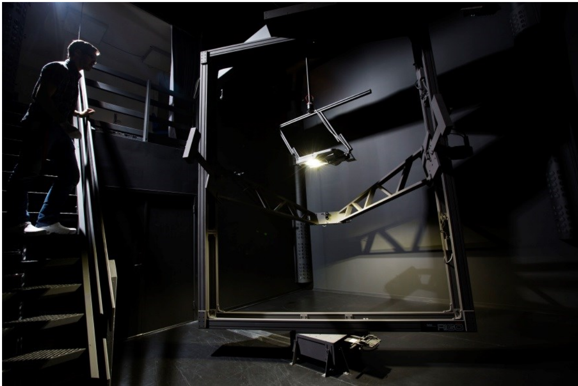
Figur 16 viser måling af et LED armatur i nær felts goniofotometer i det fotometriske laboratorium hos DTU Fotonik.
