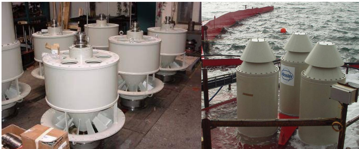
Figur 8.2 De seks aksial propel turbiner under montage hos Kössler GmbH (venstre) og 3 af turbinerne med cylinder-lukke om bord på Wave Dragon (højre)
