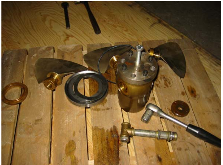
Modificering af turbine og forbindelse til generator.
