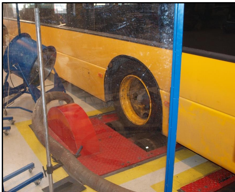
Figur 3: Lastvognsdynamometer/rullefelt til tunge køretøjer
