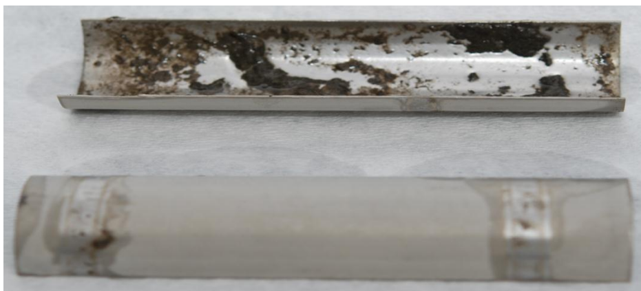
Figur 30: Billede af to af kupperne, der var monteret på rørene i fordampningskondensatoren.
