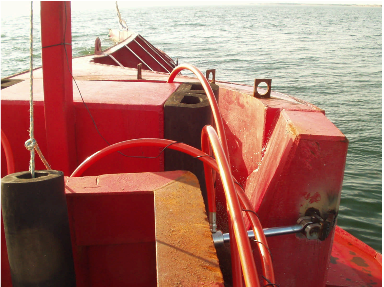
Beslag for hydraulikcylindre påsvejst under montagen af Agger Værfts folk, 12 – 15 juni 2006.
