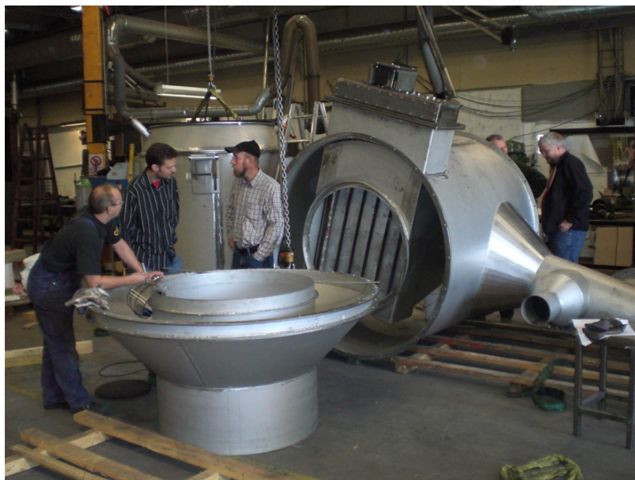
Figur 8.1 Forgasser i WEISS A/S værksted. XXX og Thomas Skipper, WEISS A/S og Ulrik Henriksen og Steen Nielsen, DTU-MEK.
