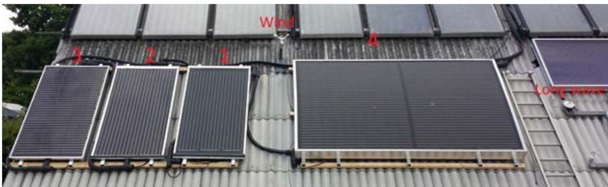
Figur 1 – Moduler monteret på prøvestand på DTU. Modulet til højre er isoleret med 10 cm på bagsiden, de øvrige med en træplade.
