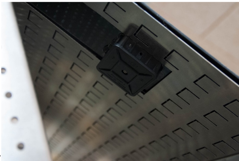
Figur 30 Udstandsning i plade for elboks på solcelle
