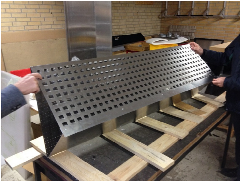
Figur 27 Aluminiumstrekant - side med udstansede kølefiner
