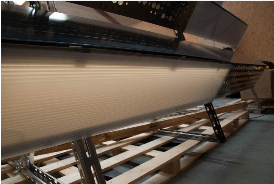
Figur 40 Inddækningsplade af polycarbonat, belyst bagfra
