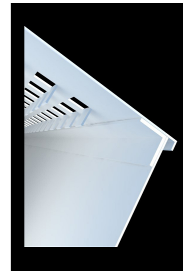
Trin 4: aluminiumsplade samles med nitter ved vinkelprofil
