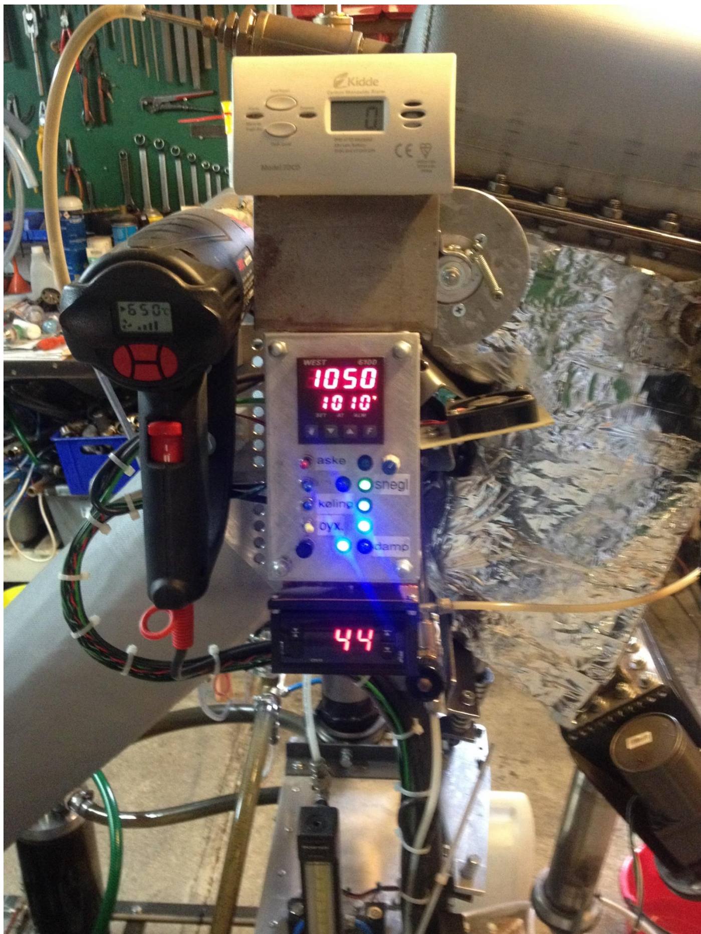
Anlæg i drift på pelleteret fiberfraktion. Temperatur i hot-sektion; 1.050 °C./ Opholdstid ca. 3 sek. Infeed: 5,1 kg/h – output 5.200 l/gas/h. Produktgastemperatur 44 °C efter filterkolonne.
