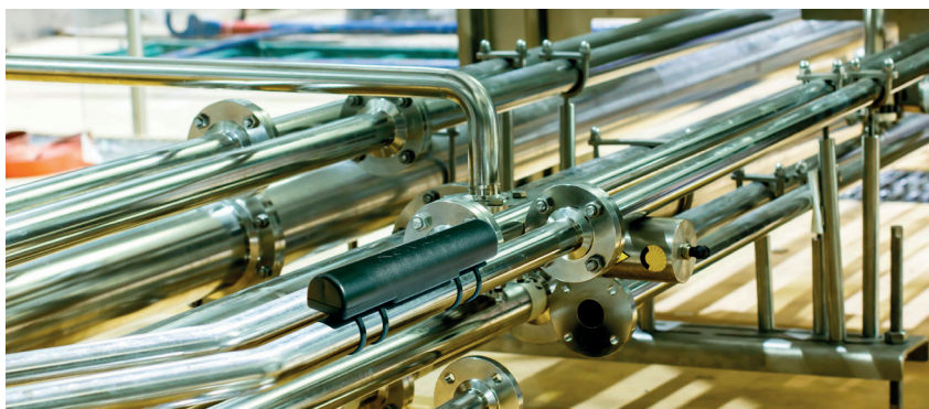
ReMoni har udviklet sensorer, der kan hæftes uden på rør og måle energi- og vandforbrug. Virksomheden betegner opfindelsen som epokegørende. Foto: ReMoni.
