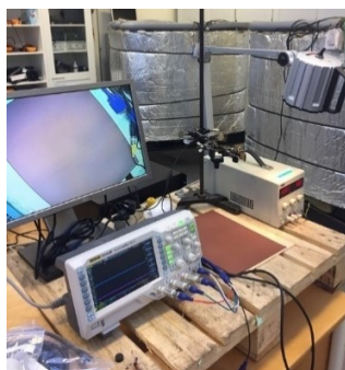
Figur 6. Forsøgsopstilling til billedgenkendelse af flistype til brug ved valg af kalibreringskurve til bestemmelse af fugtindholdet i træflis.
