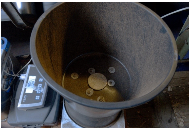
Figur 12. Opstillingen baseret på en ACO fugttransducer på Verdo.
