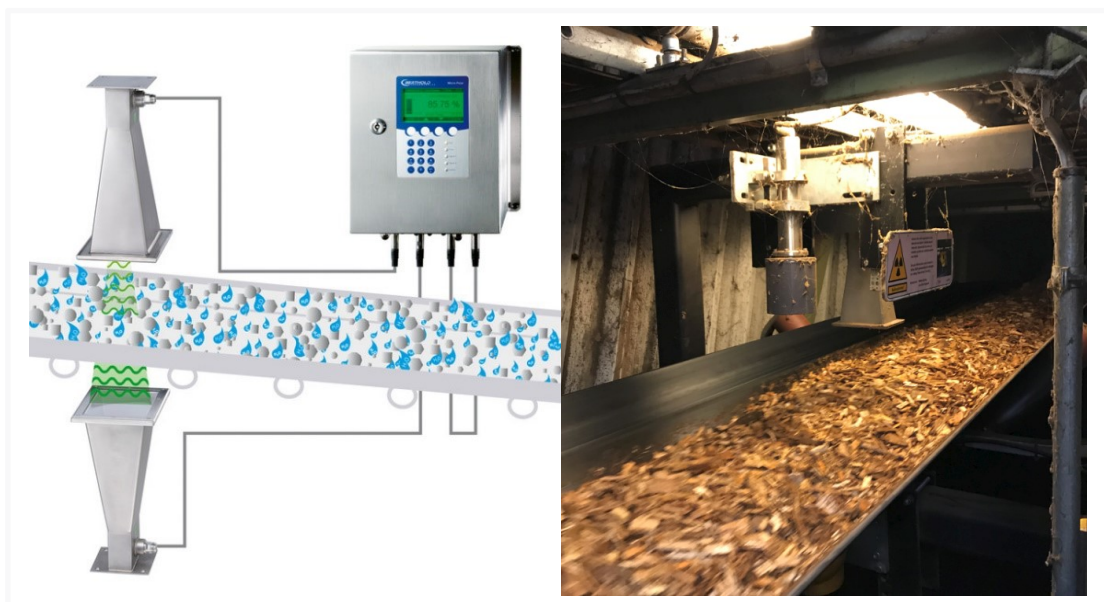
Figur 8. Fugtmåling med mikrobølger. Tv: Principskitser fra udstyrsmanualen (sender nederst, modtager øverste); th: Udstyret ses på Verdo (forest ses den radioaktive "load"-måler).
