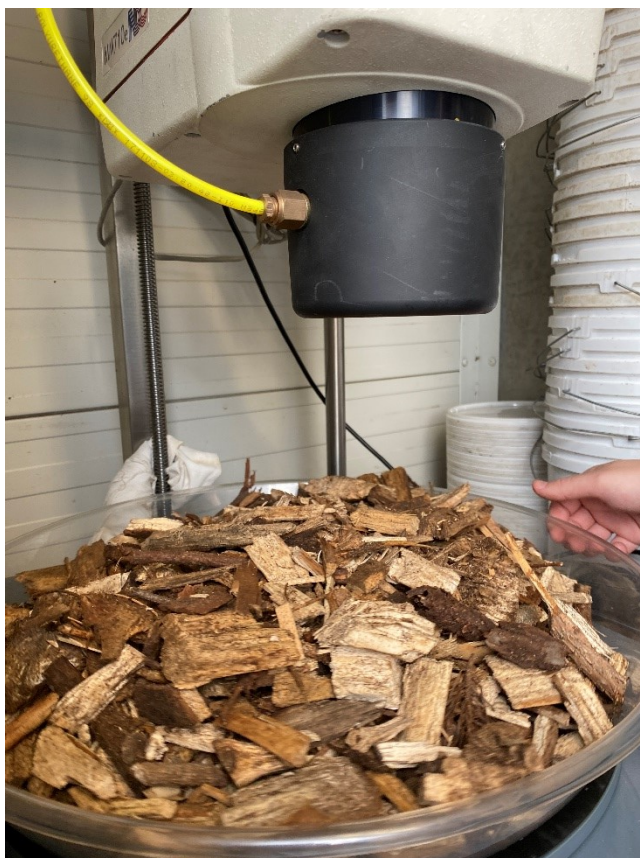
Figur 16. NIR-setup til måling af fugtindhold off-line.
