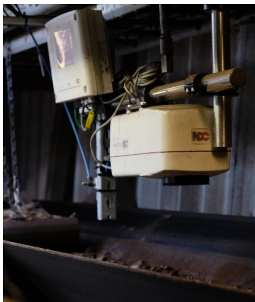
Figur 5. NIR-målinger over transportbåndet på Verdo.
