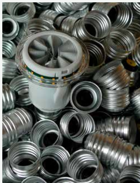
AT Lighting har 3D-printet et aluminiumskølelegeme med et 2000 lumen kraftigt LED-modul som en del af det Innovationsfonds-støttede HYPERCOOL-projekt. Kølelegemet vil blive en synlig del af den færdige lampe. To prototyper af AT Lightings CoolLED-pære fra EUDP-projektet CoolLED i et bad af gamle E27-fatninger.
