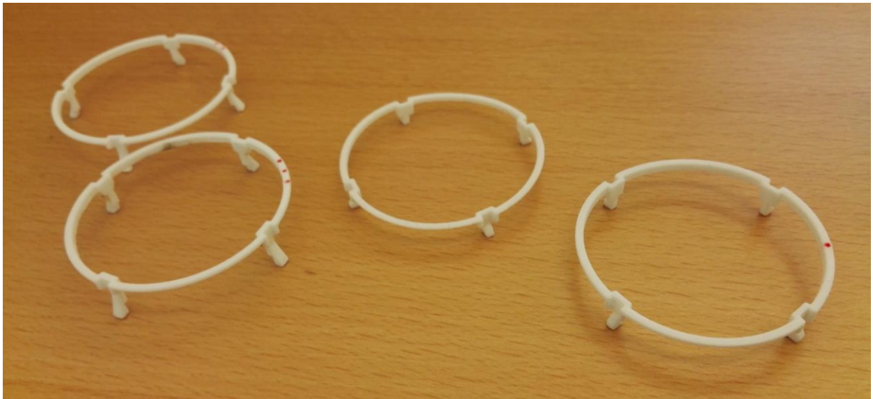
Eksempler på adapterringe udført i SLS
