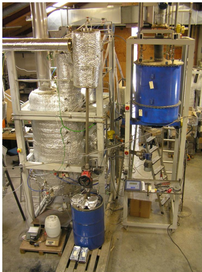
Figur 3: 100 kW LT-CFB forgasser på DTU, med brændselsindfødningsilo (blå øvre) og asketønde (blå nedre) - set fra 1. sal i forsøgshallens nordlige ende.
