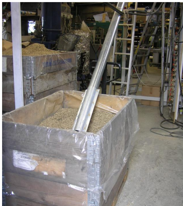
Figur 7: Automatisk opfyldning af brændselssilo fra manuelt opfyldt påslag
