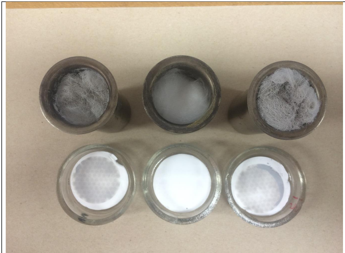
Billede 1. På billedet se tre filtre til gravimetrisk måling af askeindhold i røggas. I midten ses et ubrugt filter, og til højre og til venstre brugte filtre. En filterenhed består af et patronfilter (øverst) og et planfilter (nederst), Filtrene har i ½ time rensset røggas, der er passeret gennem high-tech filtret og kassen med metalspånner.
