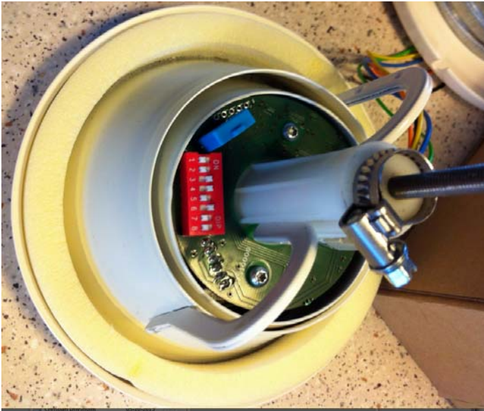
Printpladen sidder godt beskyttet mod eventuelt vandsprøjt.
