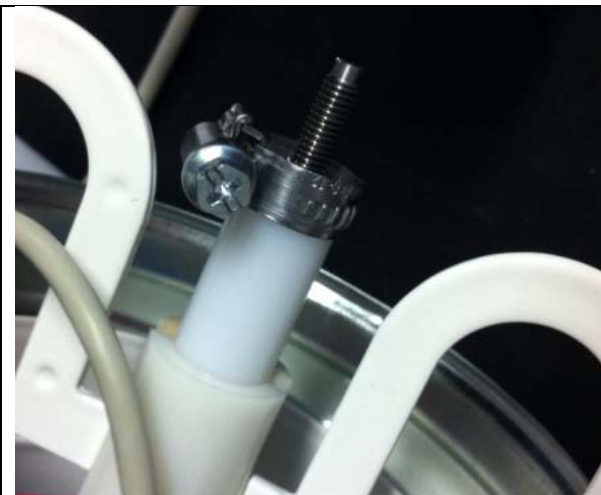
Billede af spændbånd til stopplacering af ventilvandring. På billedet sidder spændbåndet omkring 50 % nede på den hvide cylinder.
