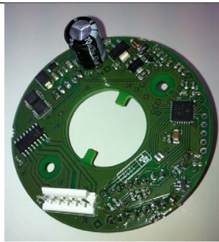
Udviklet print set fra begge sider. Den blå "karamel" er fugtighedsføleren. Temperaturføleren sidder på modsat side.
