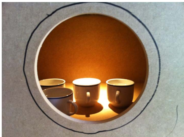
Foto af fugtforsøg på emhætte monteret med målekasse
