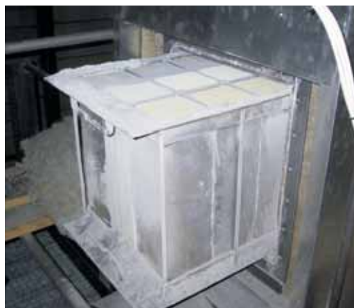
Forsøgsreaktor til undersøgelse af katalysatordeaktivering.
