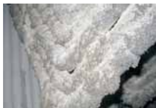
Belægninger på overhederrør på halmfyret kraftværk.
