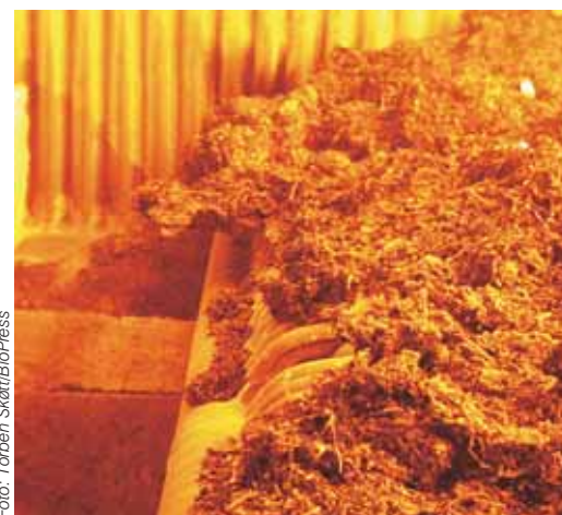
Afbrænding af halm på vibrationsrist. Ristede anlæg er i dag den mest udbredte teknologi til forbrænding af biomasse i kraftværkskedler.
