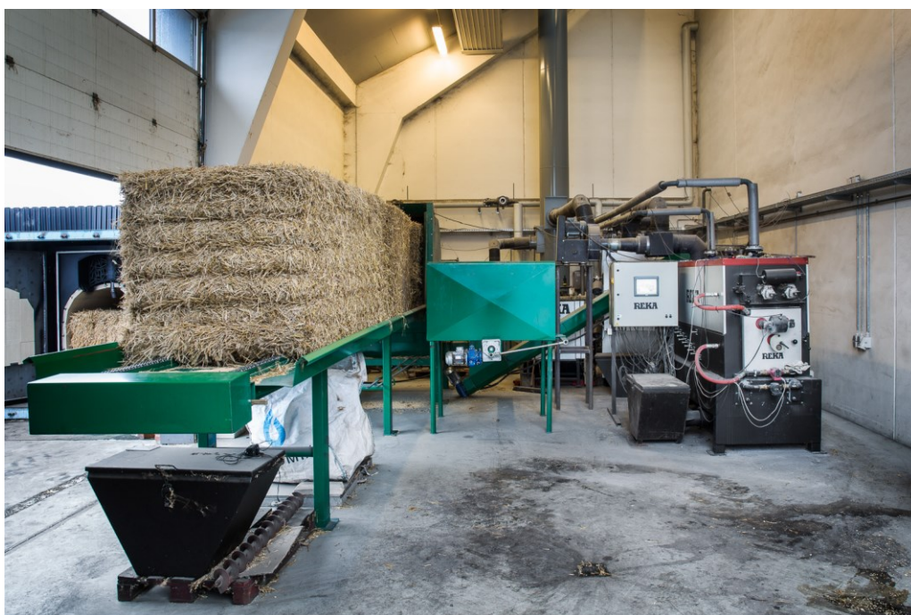
Foto 2. Test af elektrofilter i AU fyringslaboratorium. Filtret er tilsluttet en 200kW Reka biomasse kedel med stoker indfyring (Foto: Anders Trærup)
