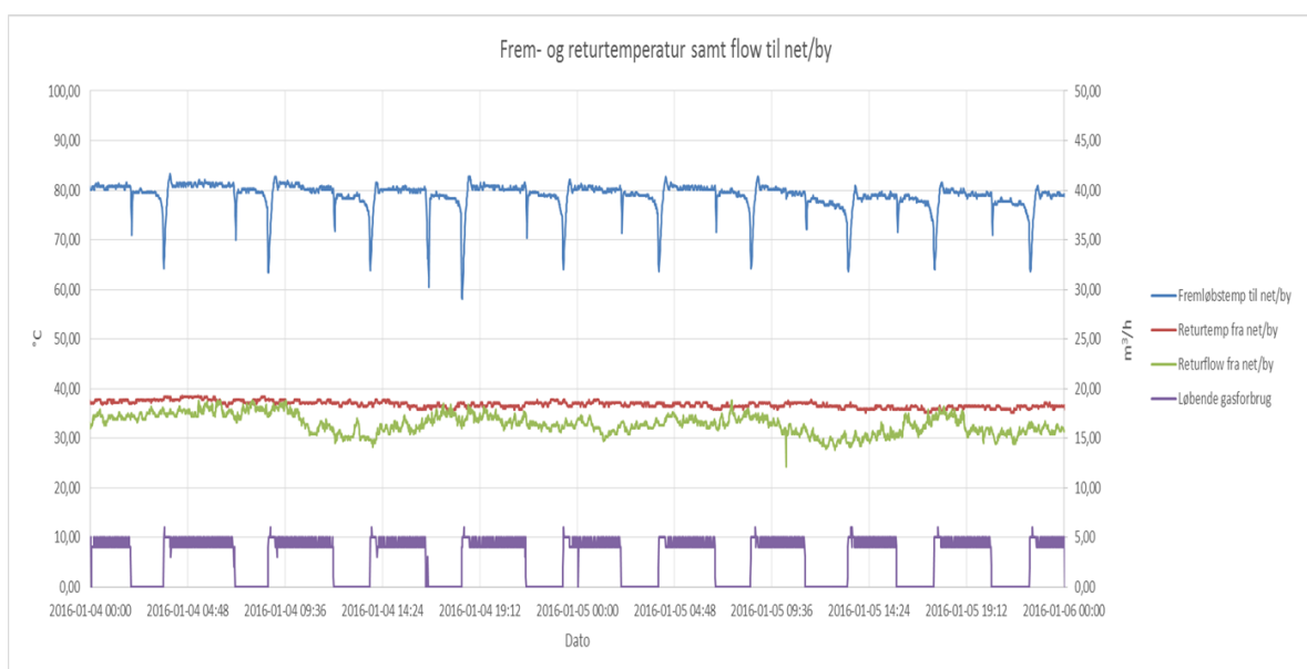
Figur 7: Fremløbs- og returtemperatur samt fjernvarme- og naturgasflow for 4. og 5. januar 2016 for Hvam – Gl. Hvam Kraftvarmeværk.
