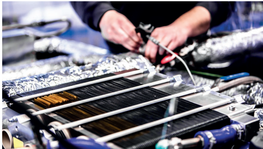
Blue World Technologies satser på at producere brændselscellestakke á 5-25 kW stykket. De kan bygges op i større moduler alt efter kundens behov. Kunden kan købe nøglefærdige anlæg eller kombinere stakkene med egne reformere og andre systemkomponenter. Foto: Blue World Technologies.
